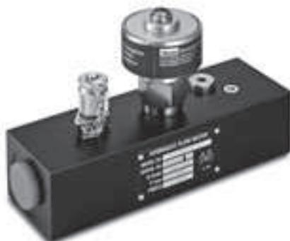
Una ruota di turbina viene azionata dal flusso di olio e fatta ruotare. Le frequenze generate vengono preparate attraverso un'elettronica digitale. Gli influssi di effetti di disturbo del flusso vengono compensati. Grazie alla ridotta resistenza al passaggio QR, il circuito idraulico viene azionato senza perdite.
