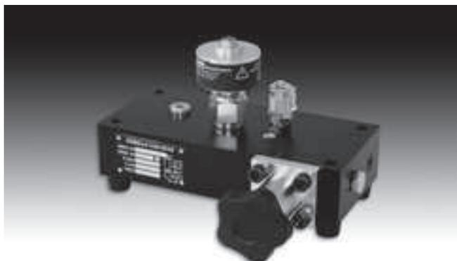
Questi tester idraulici possono essere utilizzati per la misurazione precisa di portata, pressione e temperature durante la manutenzione dei sistemi idraulici, l'individuazione delle cause degli errori sulle valvole di via regulate e la regolazione delle valvole. La valvola di messa a carico della pressione con dispositivo antiscoppio bypass consente di creare progressivamente la pressione per controllare il flusso nell'intero campo di lavoro.
