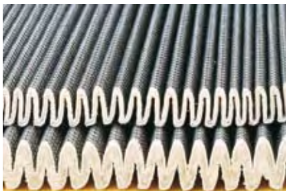
La fotografia mostra il materiale filtrante par-Gel "asciutto" e lo stesso materiale quando è dilatato dall'acqua assorbita.
