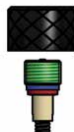
Model of valve stem 5/8" 18 UNF (D)
